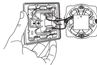
Rimuovere la linguetta sul lato del micro-modulo trasmettitore per attivare la pila.
